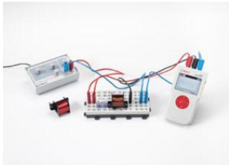
Dans l'expérience P3.6.3.4, on combine une capacité C avec une résistance R, dans l'expérience P3.6.3.5, on combine une inductance L avec une résistance R.
