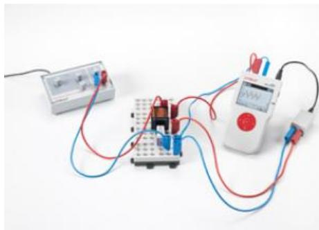
Dans l'expérience P3.6.2.4, on applique une tension alternative d'amplitude  $U_0$  et de fréquence  $f$  à une bobine. La tension  $U_L(t)$  et le courant  $I_L(t)$  sont représentés sur Mobile-CASSY 2.
