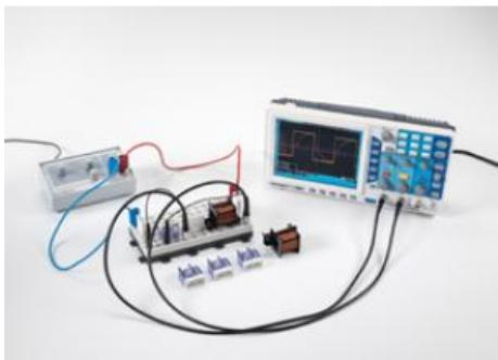
Dans l'expérience P3.6.2.1, le générateur de fonctions produit des signaux rectangulaires périodiques qui représentent l'enclenchement et la coupure d'un courant continu.
