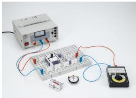
Dans l'expérience P3.6.1.3 un gros condensateur avec une longue constante de temps est chargé et déchargé lentement.
