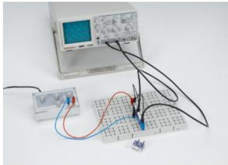
Dans l'expérience P3.6.1.2, on applique une tension alternative d'amplitude  $U_0$  et de fréquence  $f$  à un condensateur.
