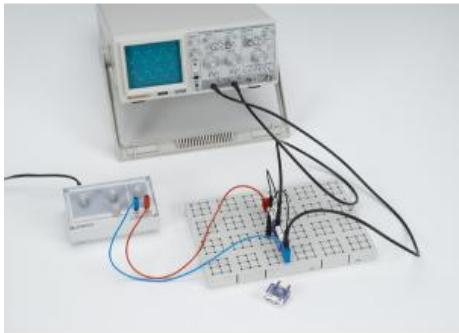
Dans l'expérience P3.6.1.2, on applique une tension alternative d'amplitude  $U_0$  et de fréquence  $f$  à un condensateur.
