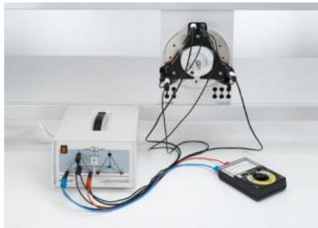
Dans l'expérience P3.5.4.4, on étudie le comportement de moteurs synchrone et asynchrone lors d'un changement du sens de rotation.
