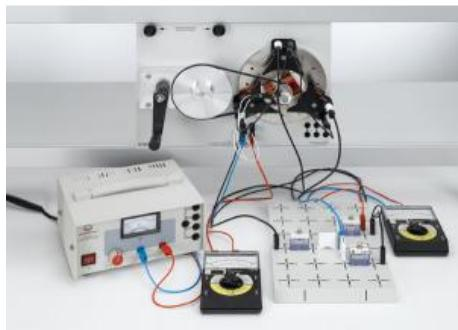
Dans l'expérience P3.5.4.3, on branche des récepteurs à l'alternateur, en montage étoile et triangle à la génératrice à courant triphasé.
