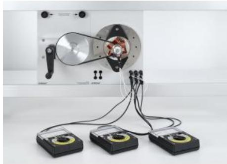
Dans l'expérience P3.5.4.1, on réalise un alternateur à pôles extérieurs à partir d'un rotor tripolaire en rotation dans un champ magnétique permanent.
