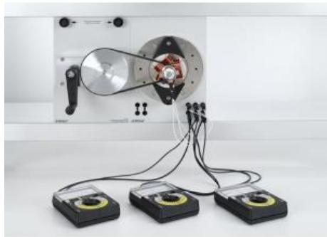
Dans l'expérience P3.5.4.1, on réalise un alternateur à pôles extérieurs à partir d'un rotor tripolaire en rotation dans un champ magnétique permanent.
