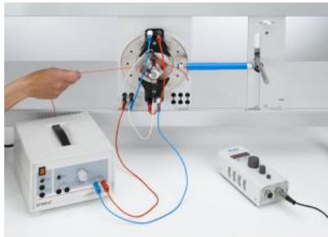
L'expérience P3.5.3.3 consiste à étudier un moteur dit universel, où les champs du stator et du rotor sont excités électriquement.
