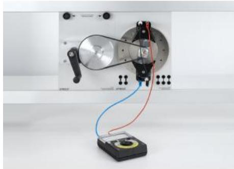
Les deux types de génératrices sont montés avec un aimant permanent dans l'expérience P3.5.2.1. On mesure la tension alternative  $U$  induite en fonction de la vitesse de rotation  $f$  du rotor. Par ailleurs, à vitesse de rotation constante, on détermine la puissance électrique  $P$  fournie en fonction de la résistance de charge  $R$ .
