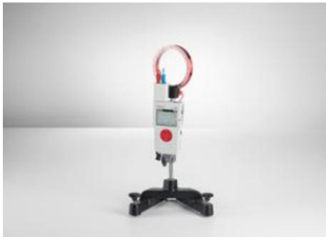
Dans l'expérience P3.4.6.2, on mesure la tension  $U(t)$  d'une bobine en rotation dans le champ magnétique terrestre.
