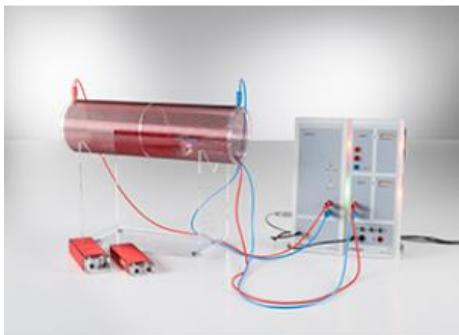
L'expérience P3.4.3.2 consiste à placer des bobines d'induction de surface et de nombre de spires différents dans une bobine de champ cylindrique, traversée par des courants alternatifs de fréquence, d'amplitude et de forme du signal différents. Si  $I(t)$  est l'intensité en fonction du temps,  $N_2$  le nombre de spires et  $L_2$  la longueur totale de la bobine, les courants produisent le champ magnétique suivant dans la bobine de champ
