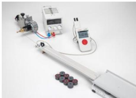
Dans l'expérience P3.4.2.1, un mobile est déplacé entre les pièces polaires d'un aimant comportant des boucles d'induction de largeur différente.
