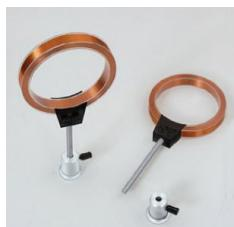
Pour la génération d'un champ magnétique homogène, par ex. pour des expériences avec les tubes de démonstration LD.
