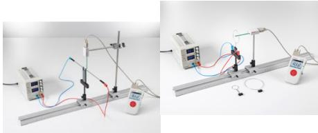
Dans l'expérience P3.3.4.4, on mesure le champ magnétique d'un conducteur droit et long pour différentes intensités  $I$  du courant, en fonction de la distance  $r$  au conducteur. Quantitativement, on confirme la relation
