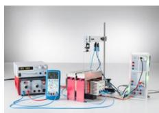
Dans l'expérience P3.3.3.2, on produit un champ magnétique homogène avec un électroaimant à noyau en U et garniture de pièce polaire.
