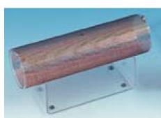
Pour mesurer l'intensité du champ magnétique en fonction du courant et du nombre de spires, pour démontrer que l'intensité du champ ne dépend pas de la surface de la bobine ainsi que pour les expériences quantitatives sur l'induction et les circuits électriques oscillants ; seulement pour les très basses tensions.
