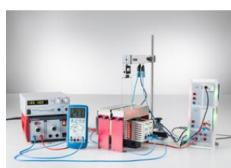
Dans l'expérience P3.3.3.2, on produit un champ magnétique homogène avec un électroaimant à noyau en U et garniture de pièce polaire.
