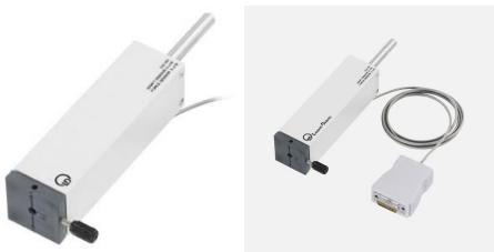
Pour mesurer des forces (par ex. électrostatiques) de  $\pm 1$  N avec CASSY ( 524013 , 524006 , 524005W , 524018 ) ou l'instrument de mesure universel Physique ( 531835 ). Avec deux lames souples à quatre jauge extensométriques montées en pont.
