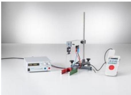
Dans l'expérience P3.3.3.1, les boucles conductrices se trouvent dans le champ magnétique d'un aimant en fer à cheval.
