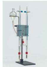
Voltamètre d'Hofmann, pour l'électrolyse de l'eau.
