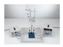
Dans lexpérience P3.2.5.1, on produit une certaine quantité dhydrogène à laide dun appareil délectrolyse selon Hofmann, afin de déterminer la constante de Faraday. Pour la valence dions hydrogène on a z = 1.
