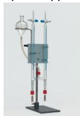
Voltamètre d'Hofmann, pour l'électrolyse de l'eau.
