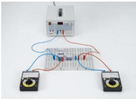
L'expérience P3.2.4.1 consiste à déterminer la résistance interne d'un ampèremètre, en relevant la chute de tension aux bornes de l'ampèremètre durant la mesure.
