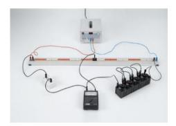
P3.2.3.4 Détermination de résistances avec un pont de Wheatstone
