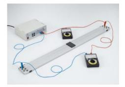
P3.2.2.1 Vérification de la loi d'Ohm et mesure de résistances spécifiques
