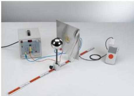
**P3.1.7.6 Mesure de la force du champ électrique d'une sphère chargée devant une plaque conductrice**
