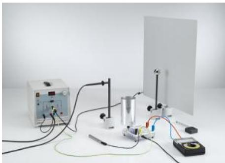
L'expérience P3.1.6.2 montre que la capacité d'un corps dépend aussi de son environnement, par exemple de la distance à d'autres conducteurs reliés à la terre.
