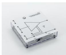
Avec entrée de tension à impédance très élevée pour la mesure de charges très faibles (jusqu'à 10<sup>-9</sup> As) et
