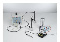
P3.1.6.1 Détermination de la capacité d'une sphère
