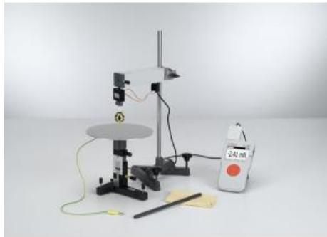
L'expérience P3.1.4.3 consiste à étudier le principe de la charge image de manière expérimentale. Pour ce faire, on mesure la force d'attraction sur une sphère électrisée, placée devant une plaque métallique. La force correspond à la force d'une charge de valeur égale et de signe opposé à une distance double  $2d$ .
