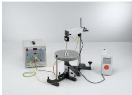
Dans l'expérience P3.1.4.2 on monte un électromètre absolu de Kirchhoff pour mesurer la force
