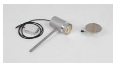
Pour la mesure du champ électrique statique (ou champ électrostatique) avec CASSY ( 524013 , 524006 , 524005W , 524018 ) ou avec l'instrument de mesure universel Physique ( 531835 ).
