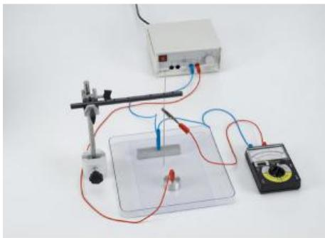
L'expérience P3.1.3.2 consiste à mesurer les lignes équipotentielles de différents corps électrisés. Pour ce faire, on applique une tension sur des paires délectrodes dans une cuve électrolytique remplie deau distillée.
