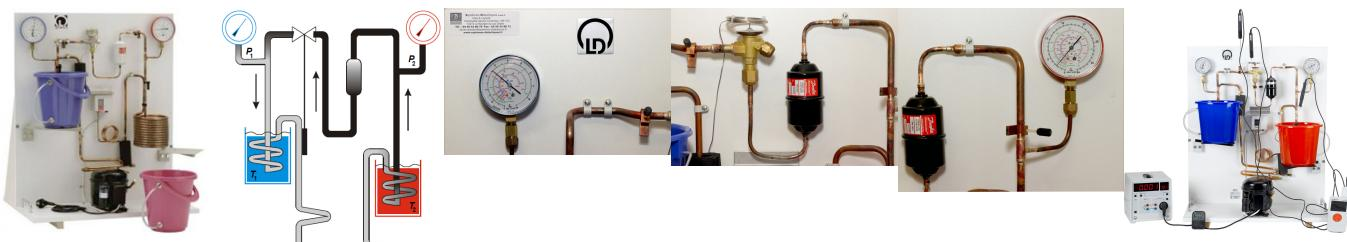
Modèle didactique d'une pompe à chaleur avec compresseur monté sur un panneau de démonstration, avec un manomètre à aiguille dans la partie basse pression et un autre dans la partie haute pression.
