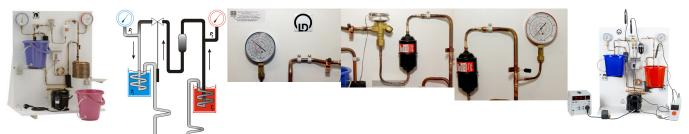
Modèle didactique d'une por pe à chaleur avec compresseur monté sur un panneau de démonstration, avec un manomètre à aiguille dans la partie basse pression et un autre dans la partie haute pression.
