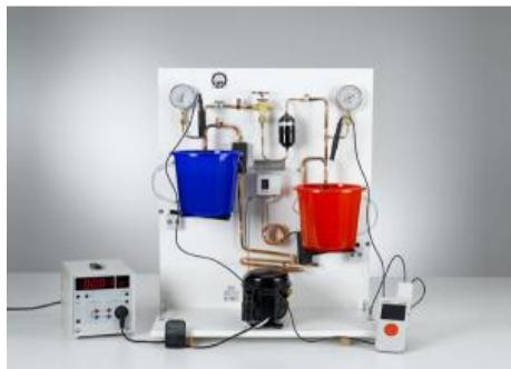
L'objet de l'expérience P2.6.3.1 est de déterminer le coefficient d'efficacité
