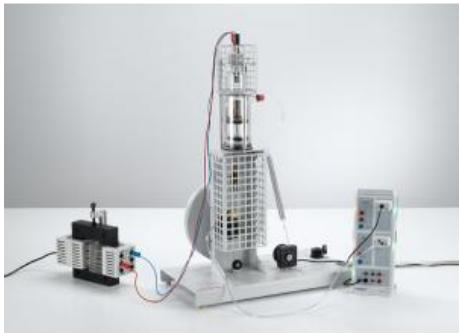
Au cours de l'expérience P2.6.2.4, on trace le diagramme pV du moteur à air chaud en tant que moteur thermique à l'aide de l'interface CASSY : un capteur de pression mesure la pression  $p$  dans le cylindre en fonction du temps  $t$  et un capteur de déplacement enregistre la position  $s$  du piston moteur à partir de laquelle le volume  $V$  enfermé est calculé.
