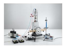
P2.6.2.2 Détermination du rendement du moteur à air chaud comme moteur thermique
