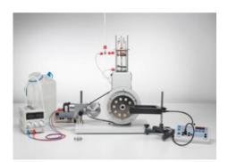
P2.6.2.1 Détermination calorique des pertes par friction
