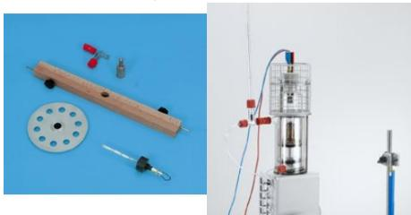
Pour la détermination quantitative du bilan des puissances, du freinage mécanique, de la mesure sans contact de la vitesse de rotation, de la mesure du débit et de la température du flux d'eau de refroidissement ainsi que pour la compensation électrique de la puissance frigorifique.
