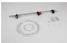
Permet de déduire l'équation d'état (transformation adiabatique), de déterminer le rapport  $c_p / c_V$  et le frottement intérieur des gaz ainsi que d'étudier la réponse en amplitude et en phase en cas de résonance.
