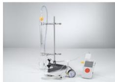
Au cours de l'expérience P2.5.2.3, on enlève de l'air à l'extrémité ouverte faisant ainsi baisser constamment la pression  $p$  dans la colonne d'air, jusqu'à ce que le volume  $V$  de la colonne d'air reste constant, même si la température baisse.
