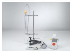
Au cours de l'expérience P2.5.2.3, on enlève de l'air à l'extrémité ouverte faisant ainsi baisser constamment la pression  $p$  dans la colonne d'air, jusqu'à ce que le volume  $V$  de la colonne d'air reste constant, même si la température baisse.
