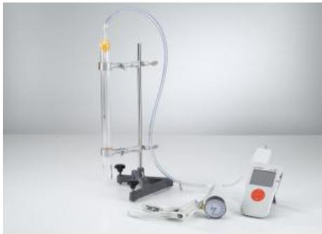
Durant l'expérience P2.5.2.1, la colonne d'air reste à température ambiante constante T. Elle a pour une pression extérieure  $p_0$  un volume  $V_0$  fermé par la bulle de mercure.
