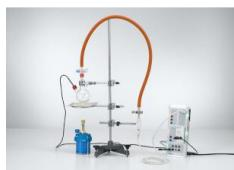
Durant l'expérience P2.4.2.1, on trace la courbe de la pression de vapeur de l'eau en dessous du point débullition normal à laide de l'interface CASSY.
