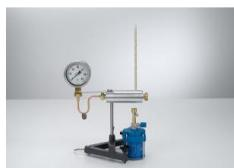
Dans l'expérience P2.4.2.2, on utilise l'appareil à vapeur sous haute pression pour des mesures de pressions jusqu'à 50 bars.
