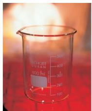
Forme basse, gradué et avec bec verseur, DIN 12 331, ISO 3819.
