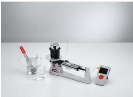
Au cours de l'expérience P2.4.1.4 , on remplit un calorimètre de glace afin de déterminer la chaleur massique de fusion, refroidissant ainsi de leau chaude à la température de mélange m.
