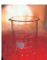
Forme basse, gradué et avec bec verseur, DIN 12 331, ISO 3819.
