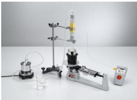
Durant l'expérience P2.4.1.3, pour déterminer la chaleur massique QV dévaporation de l'eau, on fait passer de la vapeur d'eau pure dans un calorimètre, faisant ainsi chauffer de l'eau froide à la température de mélange m. La vapeur d'eau se condense en eau du fait de la chaleur dévaporation cédée.
