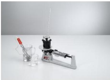
Au cours de l'expérience P2.4.1.2 , on remplit un calorimètre de glace afin de déterminer la chaleur massique de fusion, refroidissant ainsi de l'eau chaude à la température de mélange
