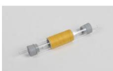
Pour obtenir des flux de vapeur sans eau de condensation lors de la détermination de la chaleur de condensation.
