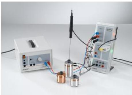
Au cours de la expérience P2.3.4.3, il s'agit de procéder à la mise en évidence expérimentale de l'équivalence entre l'énergie électrique Eel et l'énergie thermique Eth.
