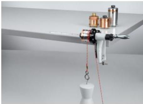
Dans l'expérience P2.3.3.1, on met en évidence l'équivalence entre énergie mécanique et énergie thermique: à l'aide d'une manivelle, on fait tourner différents récipients calorimétriques sur leurs axes, les faisant ainsi chauffer par frottement contre une corde en nylon.
