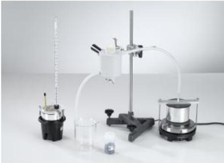
Pour déterminer la capacité thermique spécifique, on pèse au cours de l'expérience P2.3.2.1 différentes matières sous forme de grenaille, on les chauffe à la température 1 avec de la vapeur d'eau puis on les jette dans une quantité d'eau pesée de température 2.
