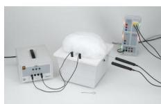
L'objectif des expériences P2.2.1.1 et P2.2.1.2 est de déterminer la conductivité thermique de matériaux de construction.
