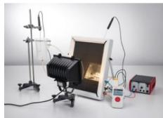
Au cours de l'expérience P2.2.1, on détermine la quantité dénergie Q cédée par unité de temps daprès lélévation de température de leau qui circule puis on estime lénergie rayonnante absorbée par unité de temps daprès la puissance de la lampe et la distance qui la sépare de labsorbeur.
