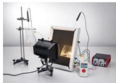
Au cours de l'expérience P2.2.1, on détermine la quantité dénergie Q cédée par unité de temps daprès lélévation de température de leau qui circule puis on estime lénergie rayonnante absorbée par unité de temps daprès la puissance de la lampe et la distance qui la sépare de labsorbeur.
