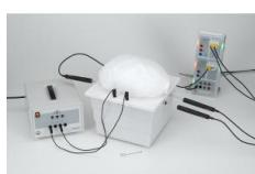
L'objectif des expériences P2.2.1.1 et P2.2.1.2 est de déterminer la conductivité thermique de matériaux de construction.
