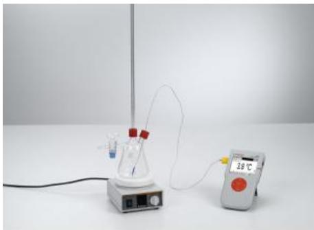
Au cours de l'expérience P2.1.3.2, on met en évidence la masse volumique maximale de l'eau en mesurant la dilatation dans un récipient avec capillaire.
