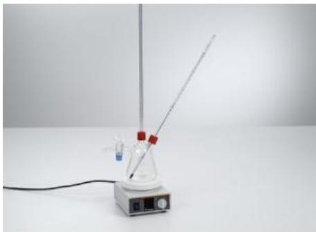
Au cours de l'expérience P2.1.3.1, on met en évidence la masse volumique maximale de l'eau en mesurant la dilatation dans un récipient avec capillaire.
